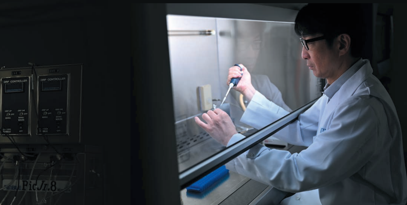
安全キャビネットの中で、マイクロピペットを使って、遺伝子組換え操作をしている乾氏。
