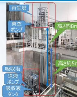
図1 ラボスケール試験機の外観
