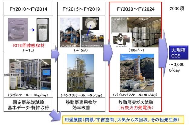
図4 固体吸収法の開発ロードマップ
