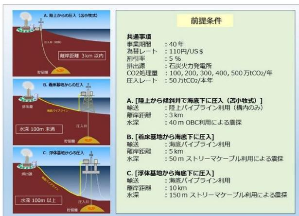
図6 比較した貯留方式
