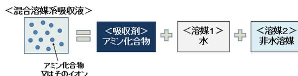
図2 混合溶媒系吸収液のコンセプト
