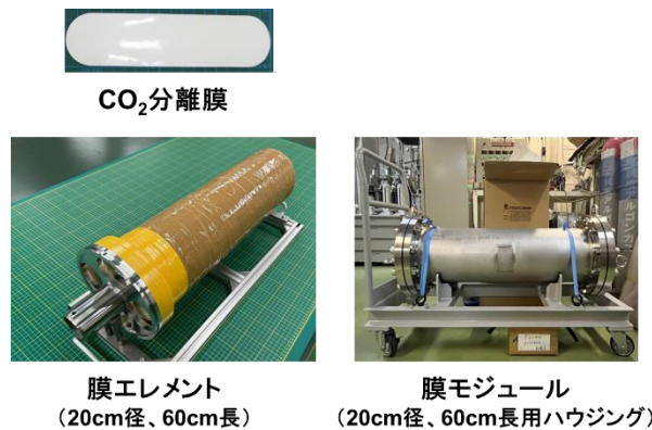
図 10 CO 2 分離膜、膜エレメント(大面積の膜、支持体および流路材等の部材を一体化したもの)および膜モジュール(膜エレメントと収納容器(ハウジング)を組み合わせたもの)
