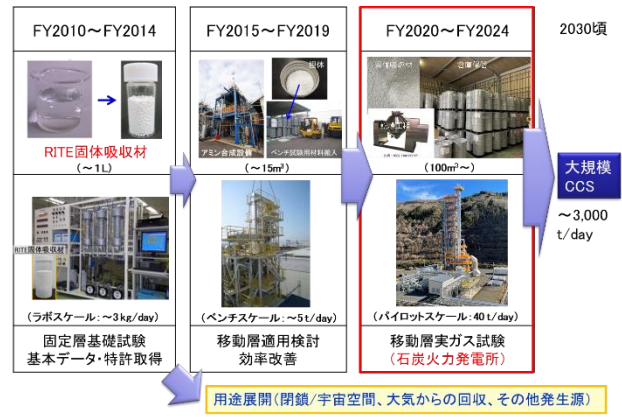
図4 固体吸収法の開発ロードマップ
